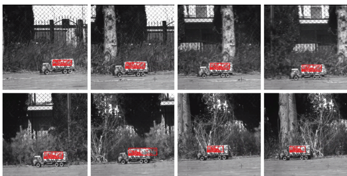
Ryc. 2. Wybrane klatki pokazujące wynik śledzenia dla scenariusza 2. Fig. 2. Selected frames showing the result of tracking for scenario 2.
